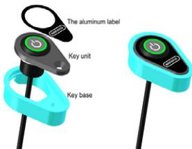
2. Montieren Sie den Hauptkörper des Displays mit der Verkabelung durch das Rohr des Kundenfahrrads hindurch.
