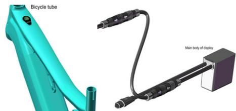
3. Schließen Sie den DP-Stecker „h“ wie angegeben an die EB-BUS-Buchse „H“ an.
